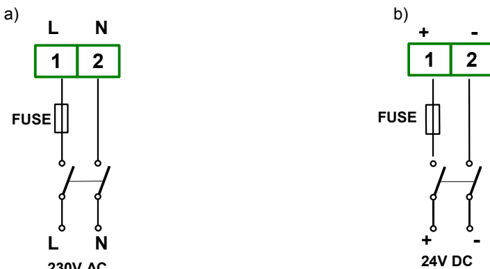
Rys. 4.7. Podłączenie zasilania a) dla wersji 230V AC; b) dla wersji 24V DC
