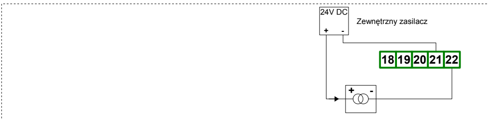
Rys. 4.11. Podłączenia przetworników prądowych 2 przewodowych
