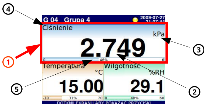
Rys. 6.8. Struktura Panelu pomiarowego
